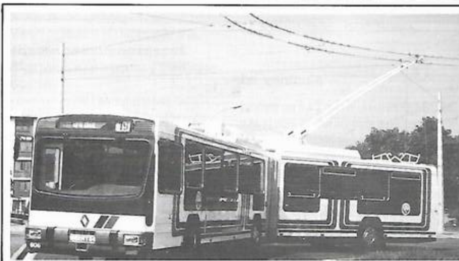
Le Trolleybus articulé bimode Renault « P.E.R. 180 H ».
