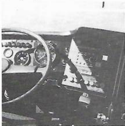
Les éléments visibles du S.A.E. dans l'autobus ou le trolleybus.
